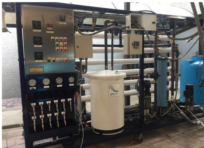
Imagen 4.3. Planta piloto de filtración por membranas
